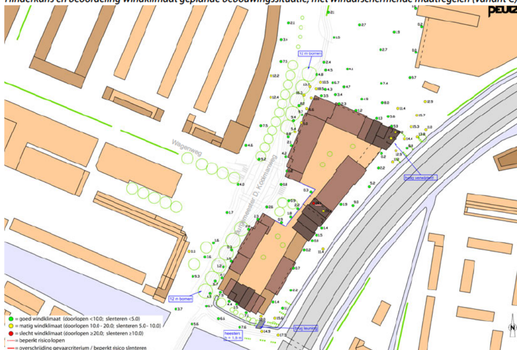
f3.7 Hinderkans en beoordeling windklimaat geplande bebouwingssituatie, met windafschermende maatregelen (variant C)
