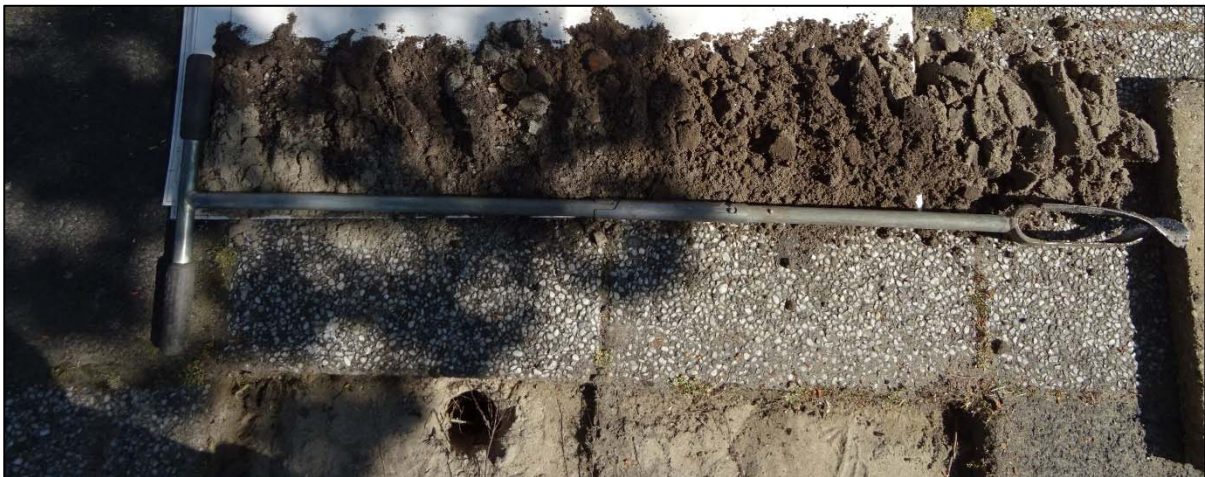
Foto profielboring bij linde nr.18: Dunne laag straat-zand onder de tegels waar een belangrijk deel van de beworteling van de lindes is gesitueerd. Tot 80 cm beneden maaiveld is de bodem matig humeus en sterk verdicht. Er is sprake van een intensieve- en sterke mate van oppervlakkige beworteling met fijne en dikke wortels dicht onder het oppervlak binnen de kroonprojecties. Op diverse diepten in het profiel is puin aangetroffen.
